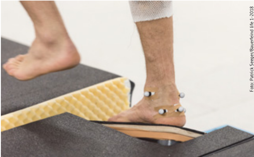
2 Die Kipp-Platte provoziert eine Supinationsbewegung des Sprunggelenks, welche mittels 3D-Bewegungsanalyse mit Spezialkameras quantifiziert werden kann.
